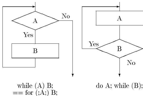
左側のwhileではまずAの条件を調べます。OKならばBを実行します。そして再びAの条件を調べます。Aの条件がOKの間Bを繰り返し実行します。実はこれはfor( ; A; ) B;と同じ働きになります。
